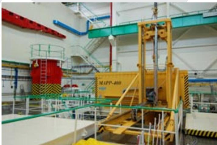
Manipulátor na prekladanie vyhoreného paliva
