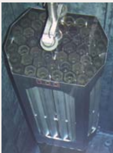
Kompaktný zásobník s vyhoreným jadrovým palivom
