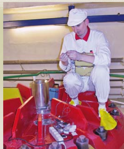
Montáž tenzometrickej aparatury na meranie uvoľnených deformácií kontajnera C-30.
