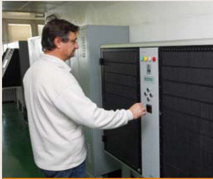
Špecialista podpory prevádzky radiačnej ochrany V1 Ing. Štefan Jursa vykonáva funkčnú skúšku zariadenia na výdaj filmových dozimetrov.
