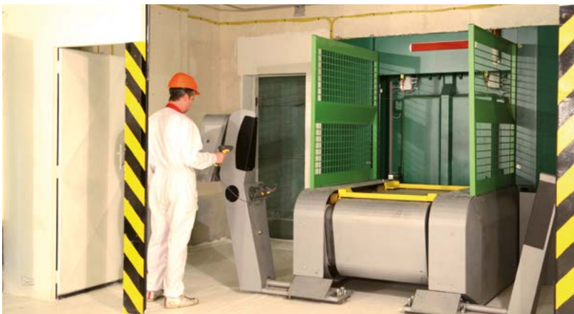
Medzi reaktorovou sálou a strojovňou je meracie stanovište, ktoré slúži na kontrolu splnenia limitov na uvoľňovanie vyradovaných materiálov do životného prostredia.
