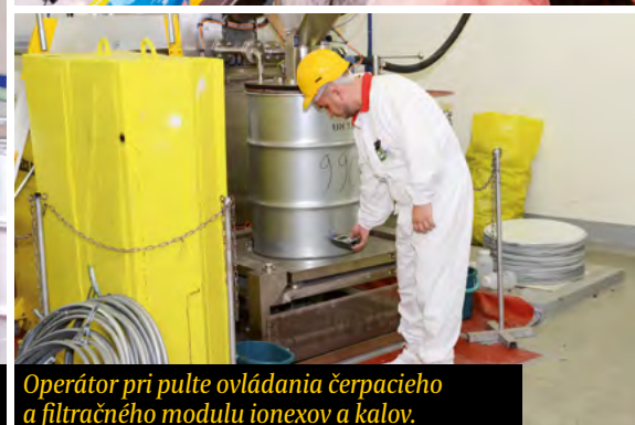
Fixačné zariadenie na zafixovanie načerpaných ionexov a kalov v 200 l MEVA sude do SIAL matrice.
