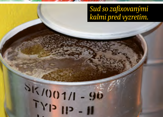
Fixačné zariadenie na zafixovanie načerpaných ionexov a kalov v 200 l MEVA sude do SIAL matrice.
