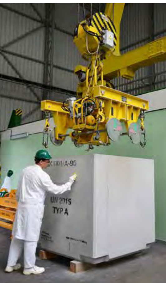
Technik radiačnej bezpečnosti Ing. Ján Sirota vykonáva kontrolu povrchovej kontaminácie vláknobetónového kontajnera s RAO pred jeho samotným uložením na úložisko. Foto: Mgr. Jana Čápková
