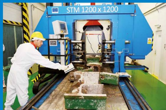
Meranie povrchovej kontaminácie kovových RAO
