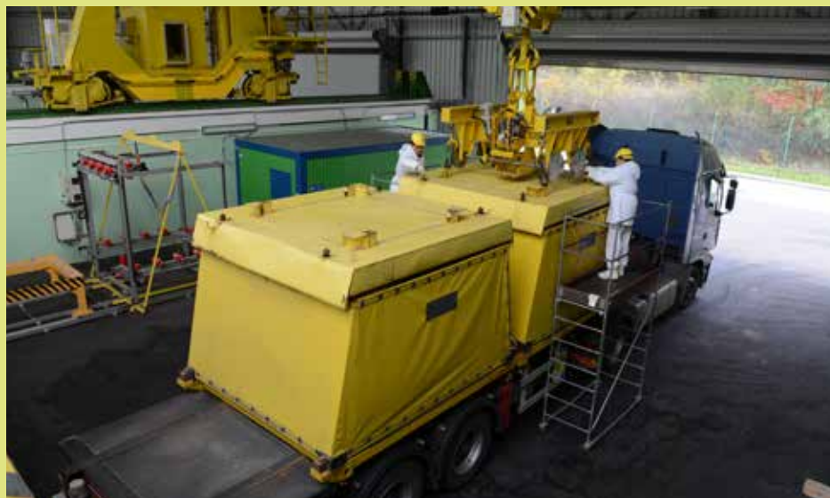
Manipulácie s vláknetónovými kontajnermi pred uložením do boxu. • Foto: Rastislav Prítrský
