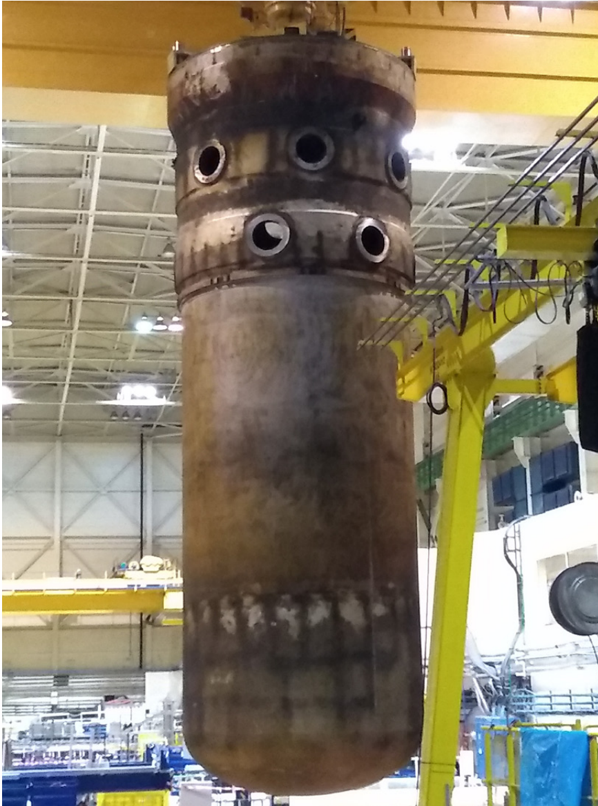
Tlaková nádoba reaktora so závesnými systémami váži 204 ton.
