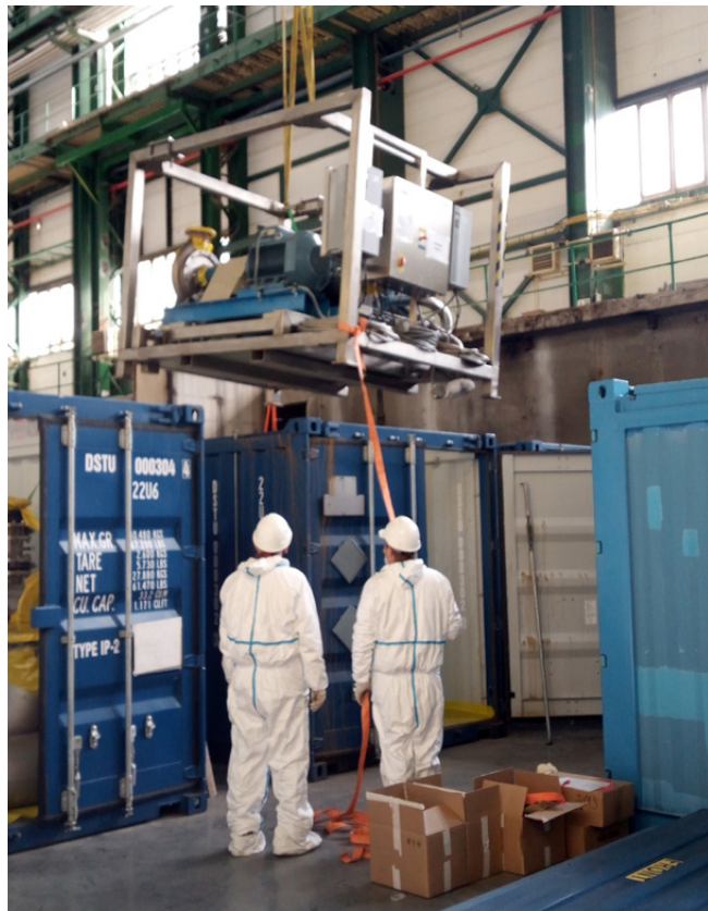
Vkladanie modulov linky DfD do ISO kontajnerov pred prepravou. Foto: Ing. Miroslav Klč
