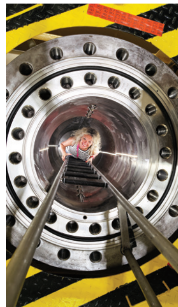
Prechod cez primárny kolektor parogenerátora.
